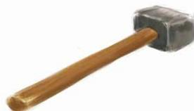
Le « **panard** » sert à fendre (dans le sens du fil) et à couper (en travers de la veine) la pierre en tapant sur le fil. L'outil est pointé à la forge. Il présente des tailles variées. L'appellation « panard » semble être spécifique aux carriers d'Erquy.
