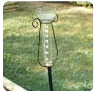
Un pluviomètre pour mesurer la quantité de pluie
